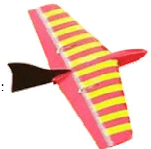
Für den typischen Frettchen-Look die Rundung des Flügels an Randbogen und Ruder anzeichnen (zB der Radius vom Sprühkleberdosendeckel ;-), den Überstand abschneiden und das EPP profilmäßig verschleifen.
