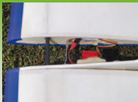
Die Flächenverbindung mit Anschlüssen
