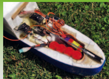
Fertig ausgebaute, ausgehöhlte Rumpfkäule mit den zwei Servos für die Trimmklappen (Innenflügel) und dem Schleppkupplungsservo
