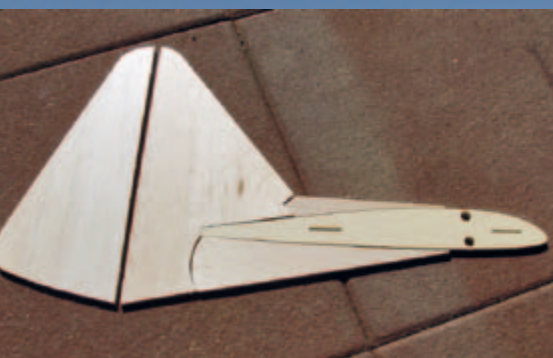
Balsa-Frästeile und Sperrholzrippe eines Seitenruders
