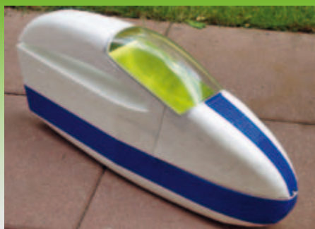
Der Rumpf mit Verstärkungs- und Deko-Tape und angepasster Haube
